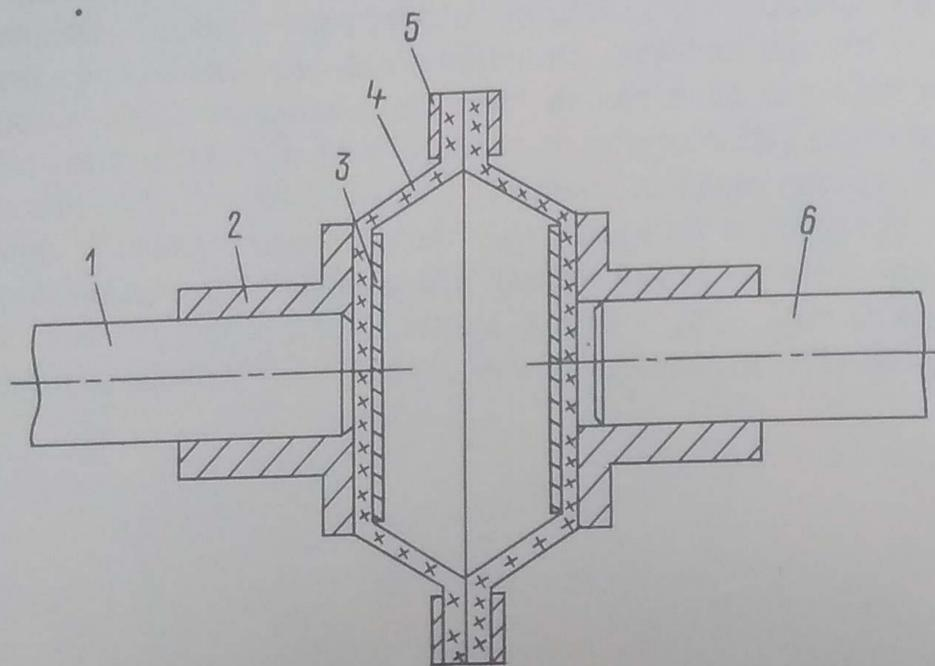
Состоит из двух полумуфт 2, насаживаемых на вал двигателя I и вал вибратора 6, и двух диафрагм 4, которые крепятся к полумуфтам кольцами 3. Диафрагмы соединяются между собой шестью болтами через кольца 5. Применение эластичной муфты значительно сокращает простои, связанные с выходом из строя муфт старой конструкции: улучшает условия труда. Муфта внедрена в производство. Годовой экономический эффект 0,8 тыс. руб. Изделие не поставляется. Имеются рабочие чертежи: ГИ9-482.
